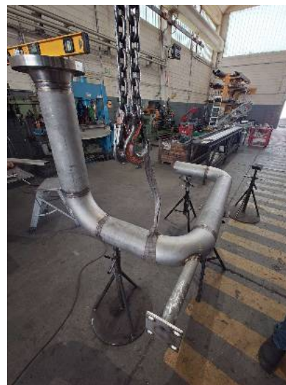
Tubazione per impianto H2
