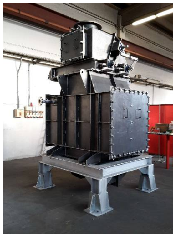
Economizzatore con struttura di supporto
