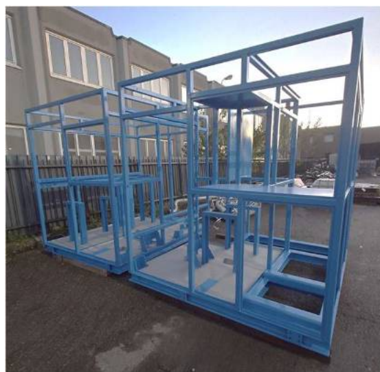
Struttura per impianto pilota generazione H2
