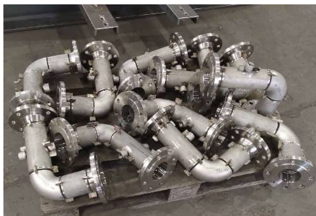
Tubazioni per impianto chimico
