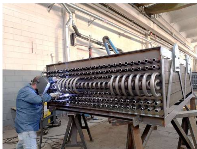
Economizzatore per vetreria PS = 12 barg – TS = 250 °C Calore scambiato: 4680 kW Peso: 4,7 ton
