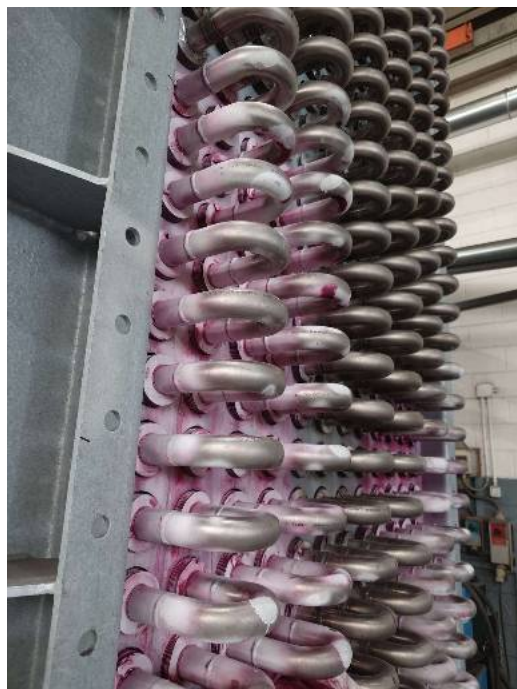
Esame PT giunti saldati
