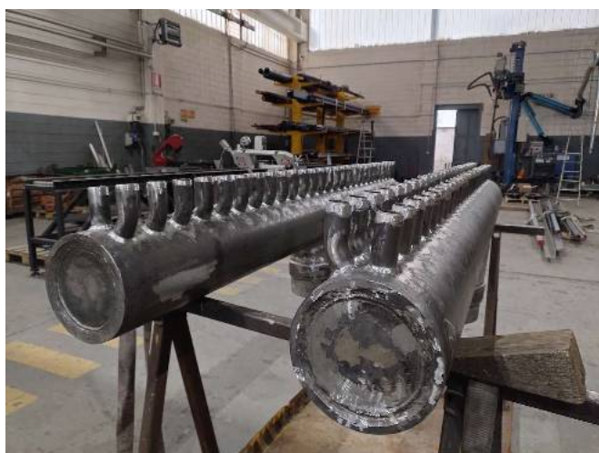
Collettore doppio alimento per economizzatore PS = 12 barg – TS = 250 °C
