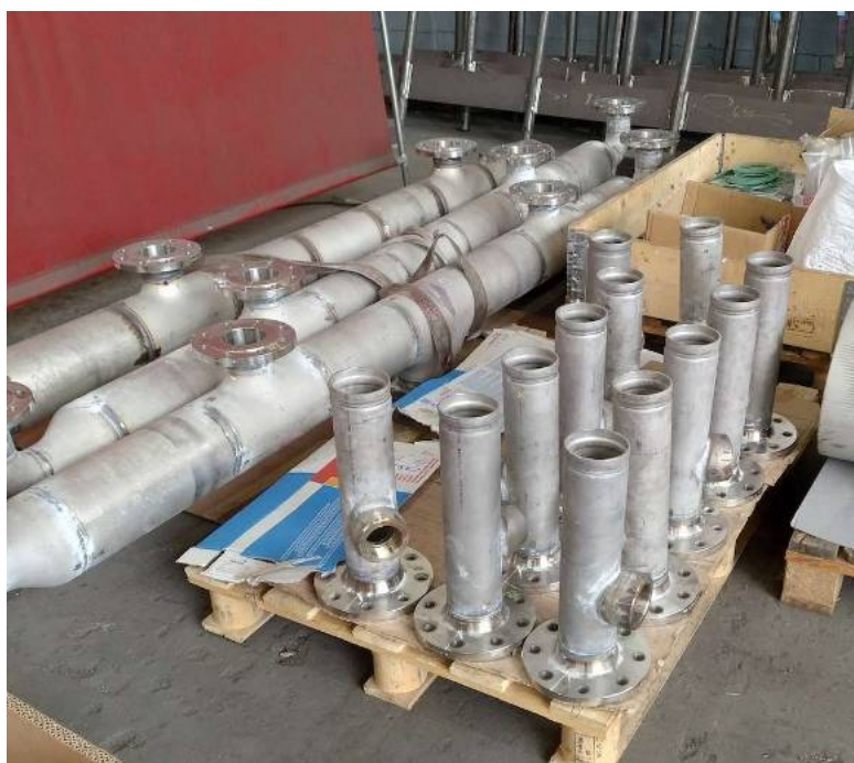
Tubazioni per impianto antincendio
