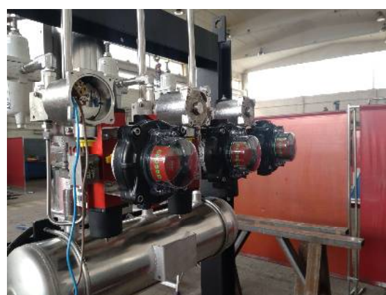
Skid filtro autopulente – Test elettrovalvole
