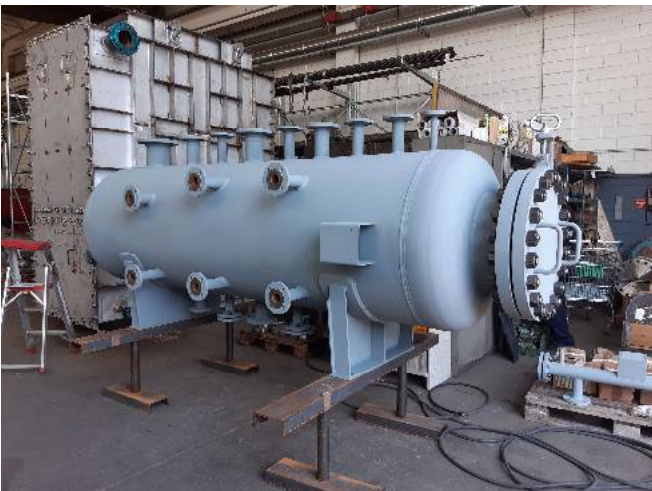
Corpo cilindrico per generatore di vapore PS = 20 barg – TS = 230 °C
