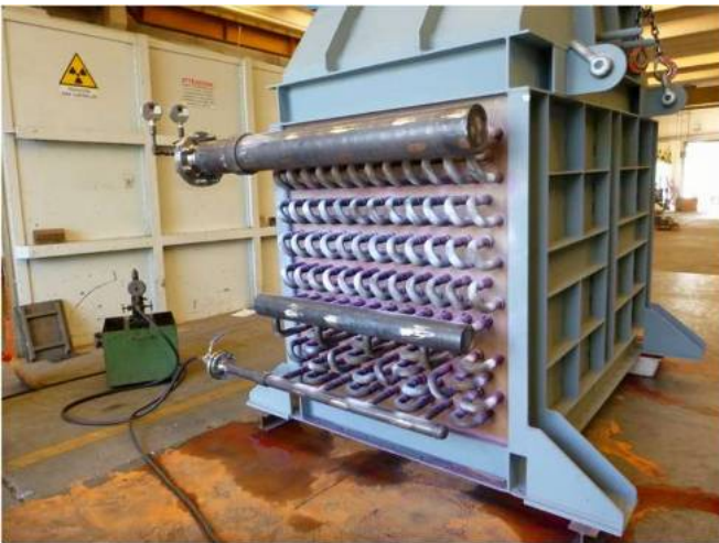
Scambiatore per impianto chimico PS = 12 barg – TS = 205 °C Calore scambiato: 1250 kW Peso: 7,5 ton
