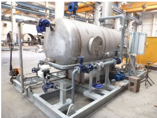
Skid degasatore per industria alimentare PS = 0,5 barg – TS = 110 °C
