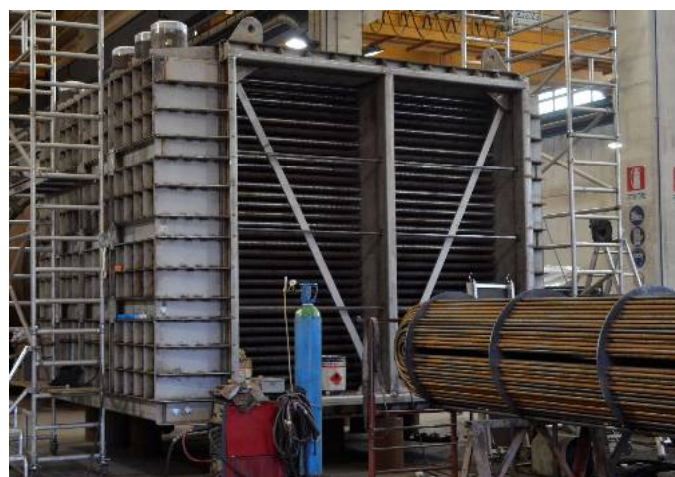
Generatore vapore surriscaldato
