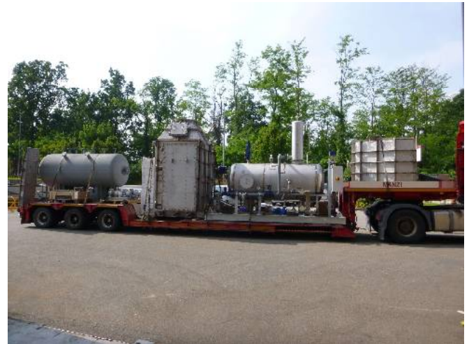
Impianto per produzione vapore da gas di scarico turbina con bruciatore in vena PS = 12 barg – TS = 300 °C Calore scambiato: 2000 kW
