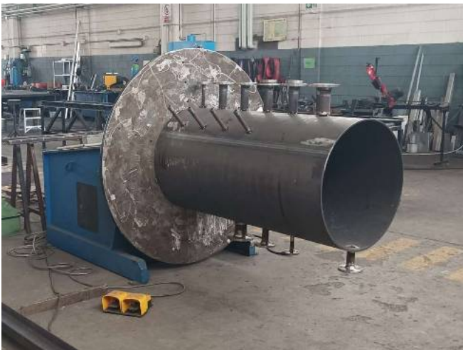
Corpo cilindrico per generatore di vapore PS = 8 bar – T = 200 °C
