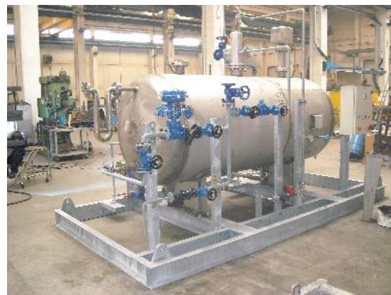
Skid degasatore per impianto alimentare
