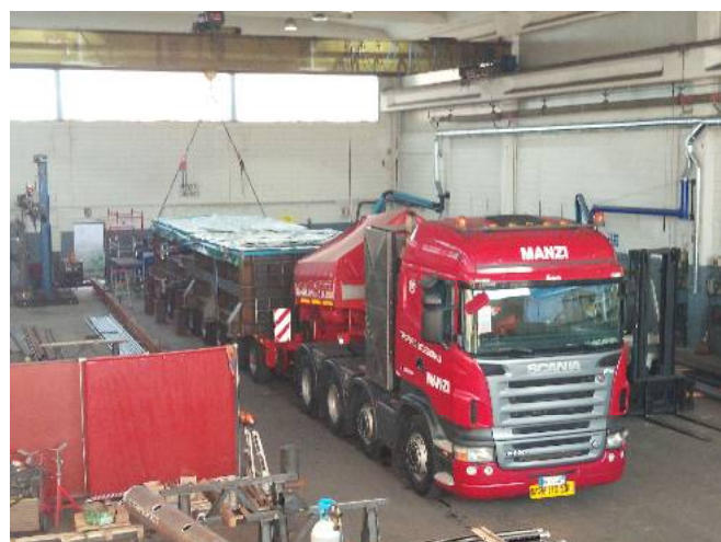
Generatore di vapore per impianto PS = 60 barg – TS = 316 °C Calore scambiato: 3000 kW Peso: 25 ton
