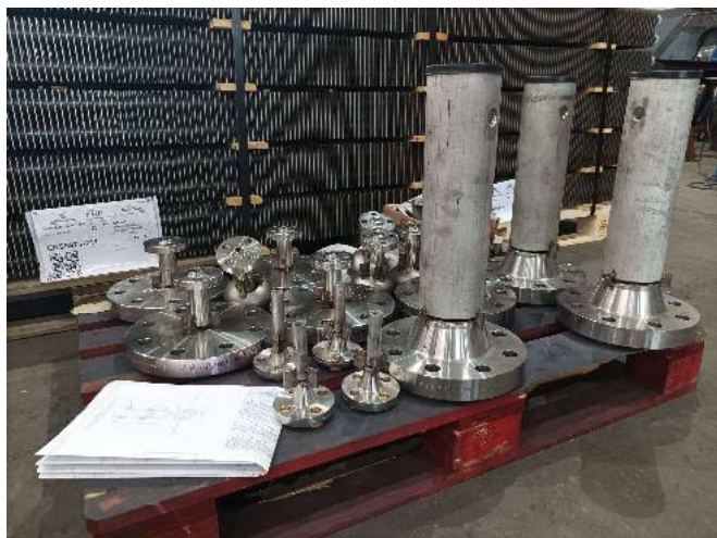
Filtri gas metano ad alta pressione
