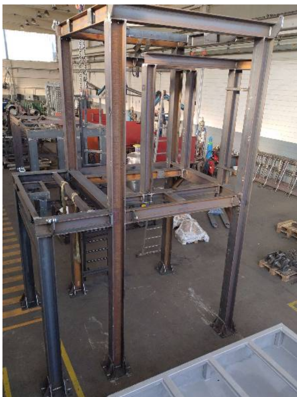
Struttura di supporto impianto filtrante He
