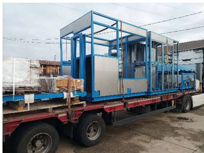
Struttura per impianto pilota per la produzione di idrogeno
