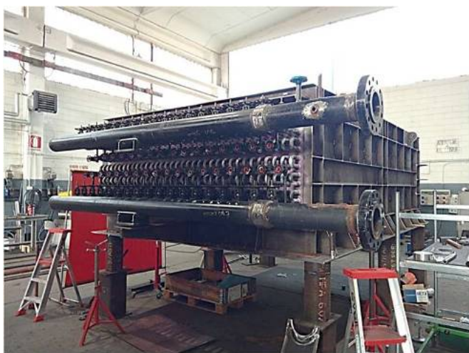
Economizzatore PS = 60 barg – TS = 316 °C Calore scambiato: 3000 kW Peso: 25 ton
