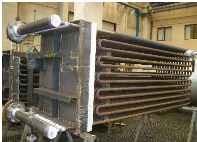
Generatore di vapore per impinto H_2SO_4
