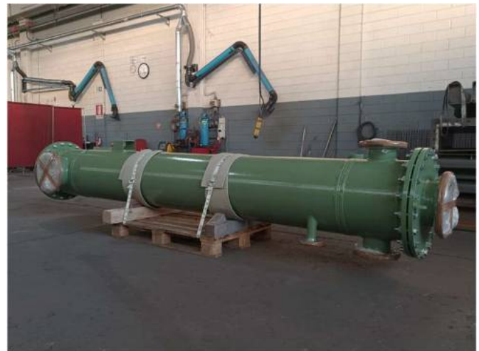
Intercooler Shell&Tube su impianto di compressione gas PS = 6 barg – TS = 100 °C
