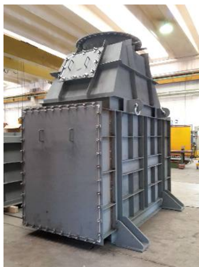
Scambiatore di calore per impianto chimico
