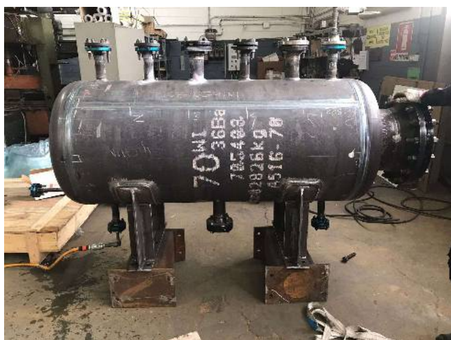
Corpo cilindrico per generatore di vapore PS = 12 barg – TS = 200 °C
